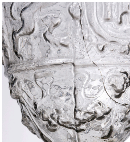
Fig. 5 Première couture verticale du moule, à gauche du blason de la ville. Décalage dans la ligne de séparation du registre (© J.-L. Elias, IRPA-KIK, Bruxelles).
