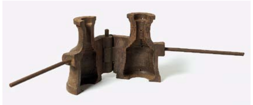
Fig. 10 Moule de verrier en fonte (fermé et ouvert), bivalve, percé de petits événements, pour une forme soufflée-tournée, XIX e s. (Coll. privée, L. avec poignée : 50 cm). (© KIK-IRPA, Bruxelles, Jean-Luc Elias)
