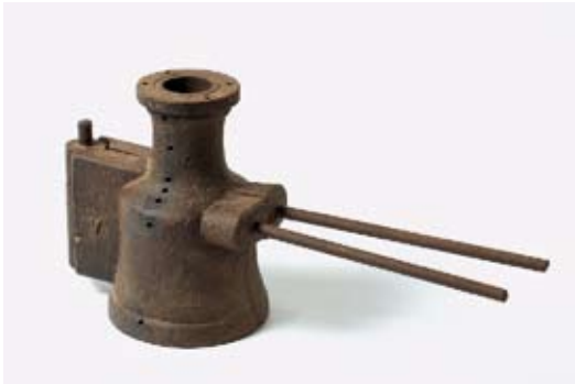
Fig. 10 Moule de verrier en fonte (fermé et ouvert), bivalve, percé de petits événements, pour une forme soufflée-tournée, XIX e s. (Coll. privée, L. avec poignée : 50 cm). (© KIK-IRPA, Bruxelles, Jean-Luc Elias)
