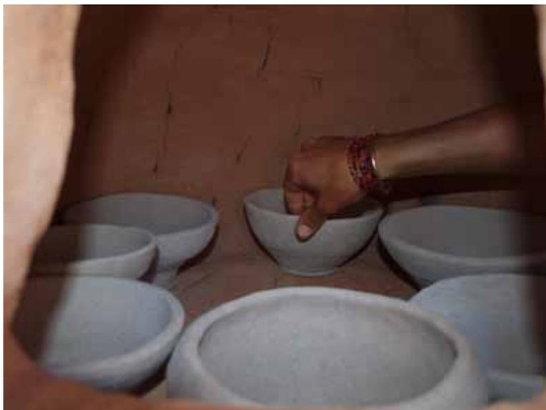
Fig. 2 Placement des creusets autour de l'oeil. (© Les infondus)
